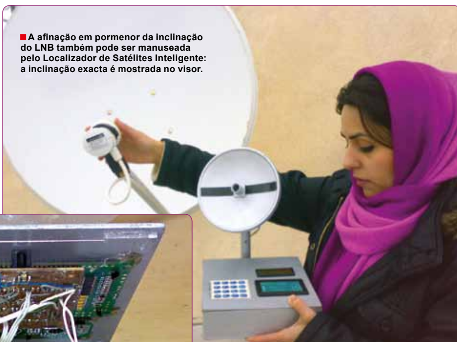
■ É assim que é usado o Localizador de Satélites Inteligente: mostra a posição dos satélites que podem receber e a antena é montada paralelamente à antena do aparelho.
