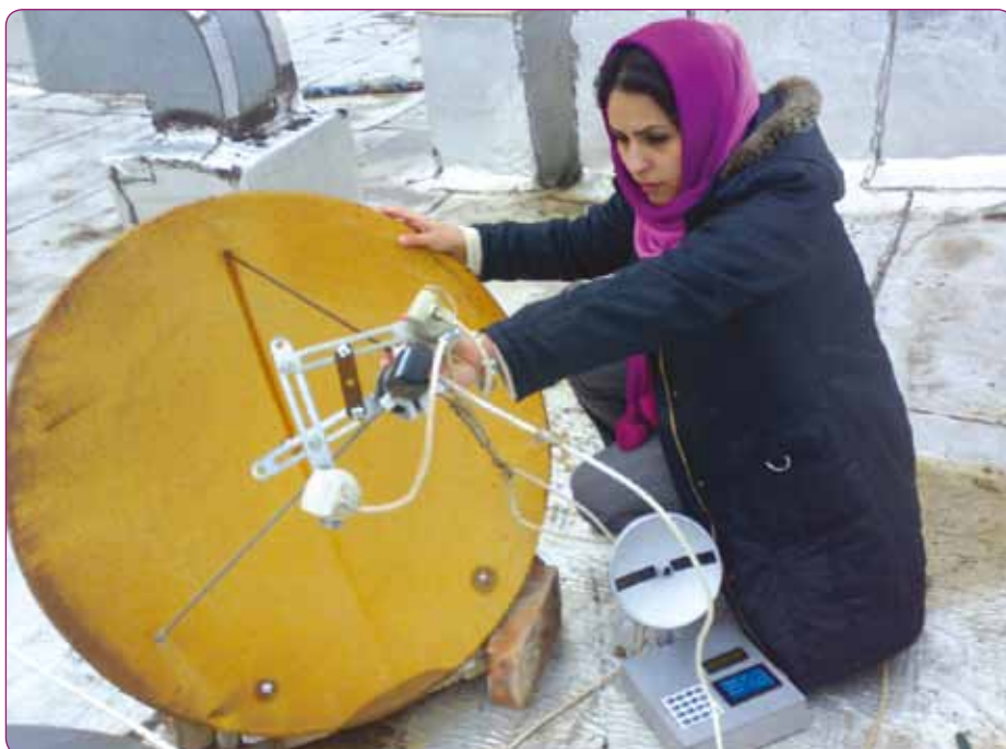
■ É assim que é usado o Localizador de Satélites Inteligente: mostra a posição dos satélites que podem receber e a antena é montada paralelamente à antena do aparelho.
