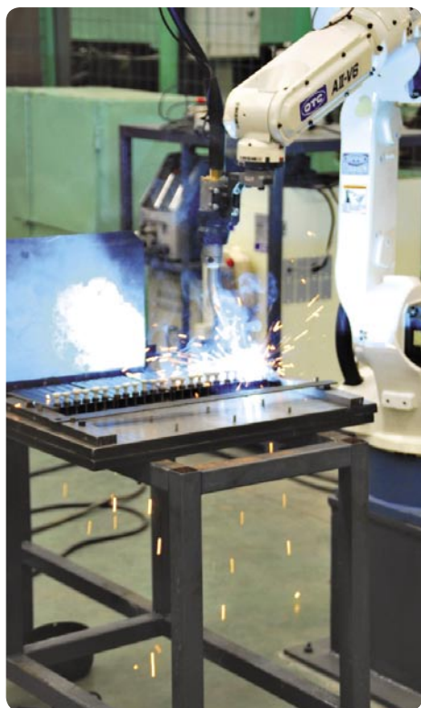
■ Robôs de soldagem automáticos são utilizados na produção das barras de apoio.
