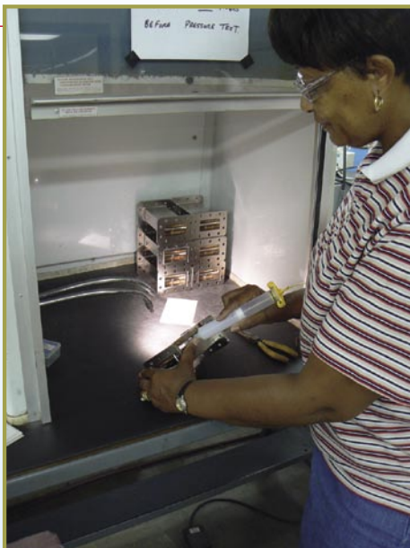
■ A sonda de recepção do filtro é colocada no seu lugar pela Vertell Brantley. A cola utilizada precisa de assentar durante três horas, os filtros são armazenados nesta câmara que do ar circundante. Depois os filtros ficam protegidos de condições meteorológicas.
