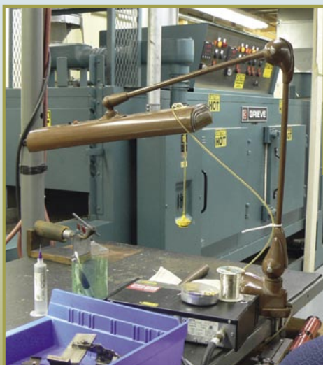
■ ... Os filtros passam por um processo próprio de soldadura que tem lugar neste fogão de soldagem.
