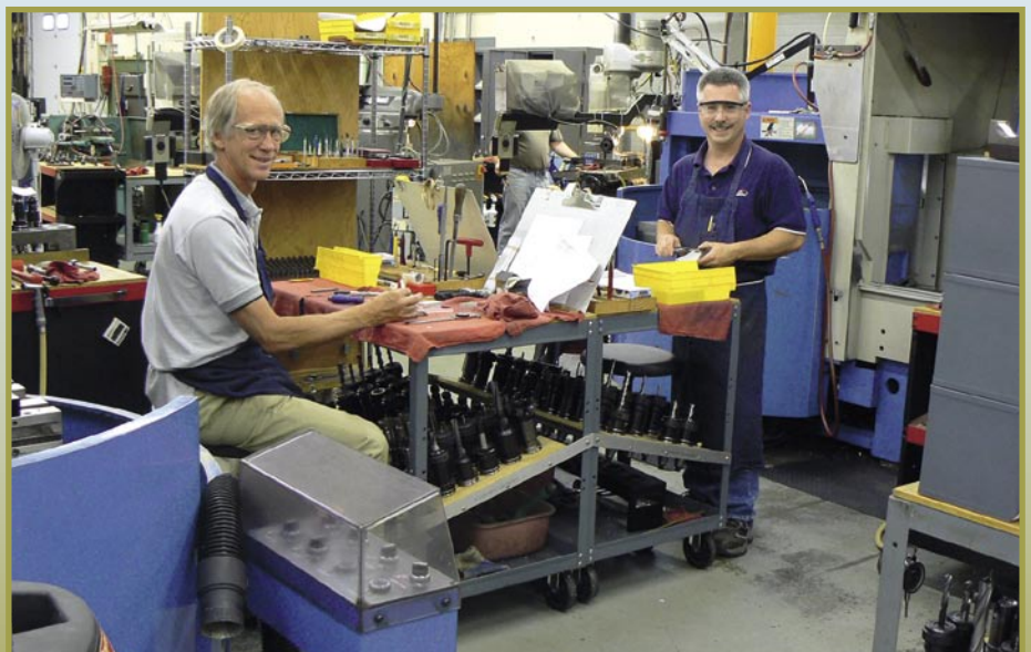
■ Na fresadora CNC temos Bruce Sentoff (esquerda) e Dale Newton (direita). Os corpos de muitos modelos de filtros são produzidos aqui fora de blocos sólidos. "Programamos as máquinas à noite para depois serem executadas automaticamente durante a noite", explica Bruce Sentoff
