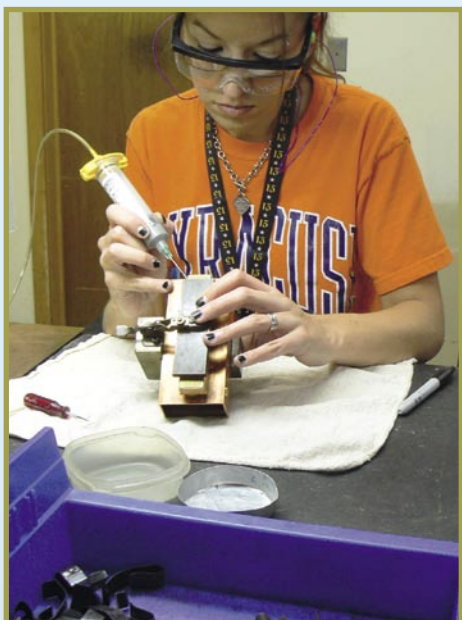
■ Aqui o filtro é mecanicamente montado. A empregada da MFC Melissa Bench prepara um filtro para o fogão de soldagem...
