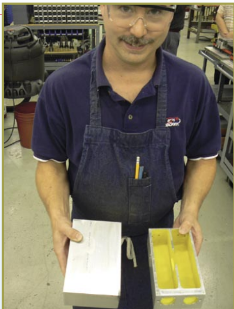
■ Dale Newton mostra a sequência da produção: fora de um bloco sólido de alumínio (à esquerda) o corpo completo de um filtro foi moído para ter todas as aberturas dos conectores e parafusos (direita).
