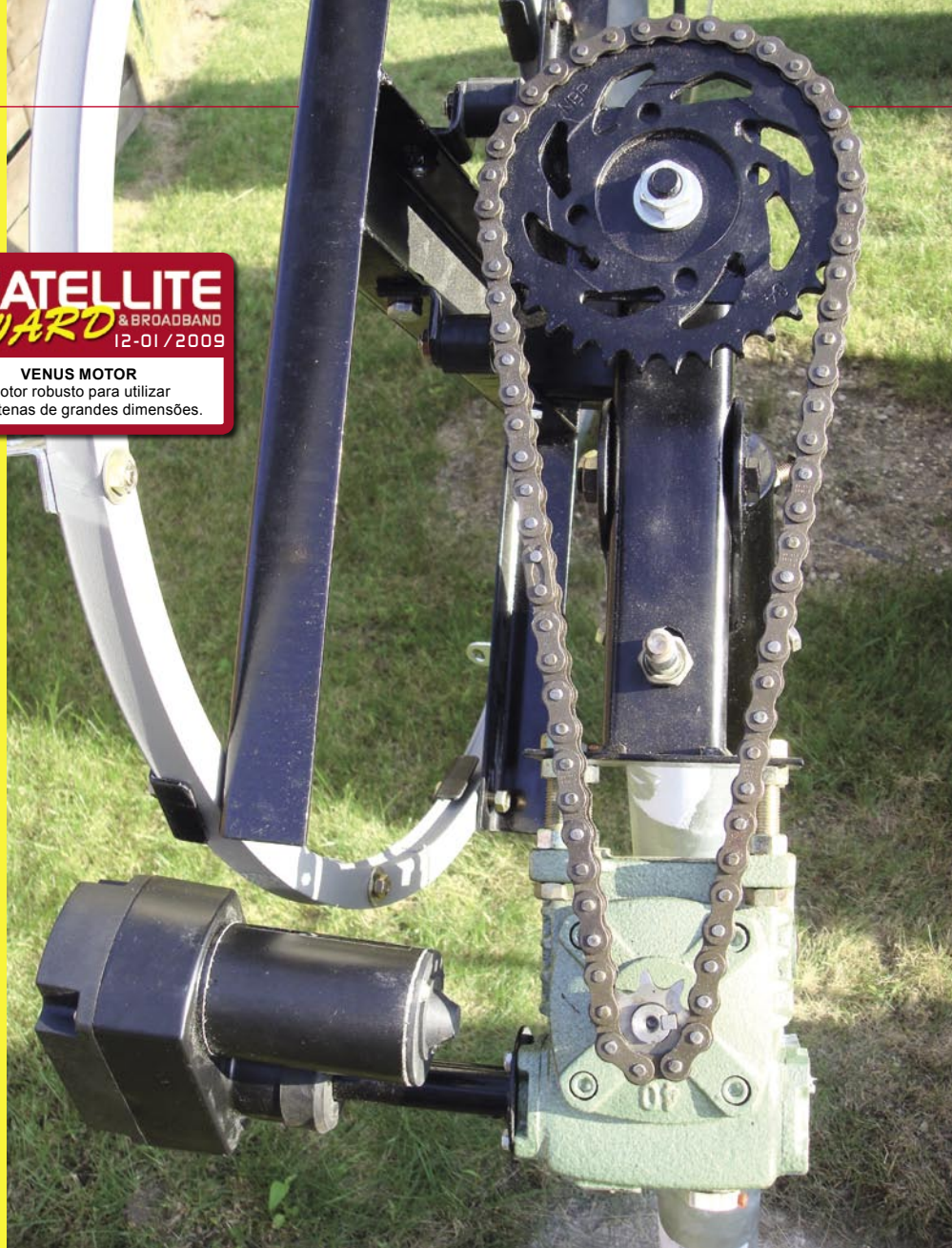
■ Motor da PT. Subur Semesta com uma corrente de transmissão da caixa de velocidades a partir do eixo
