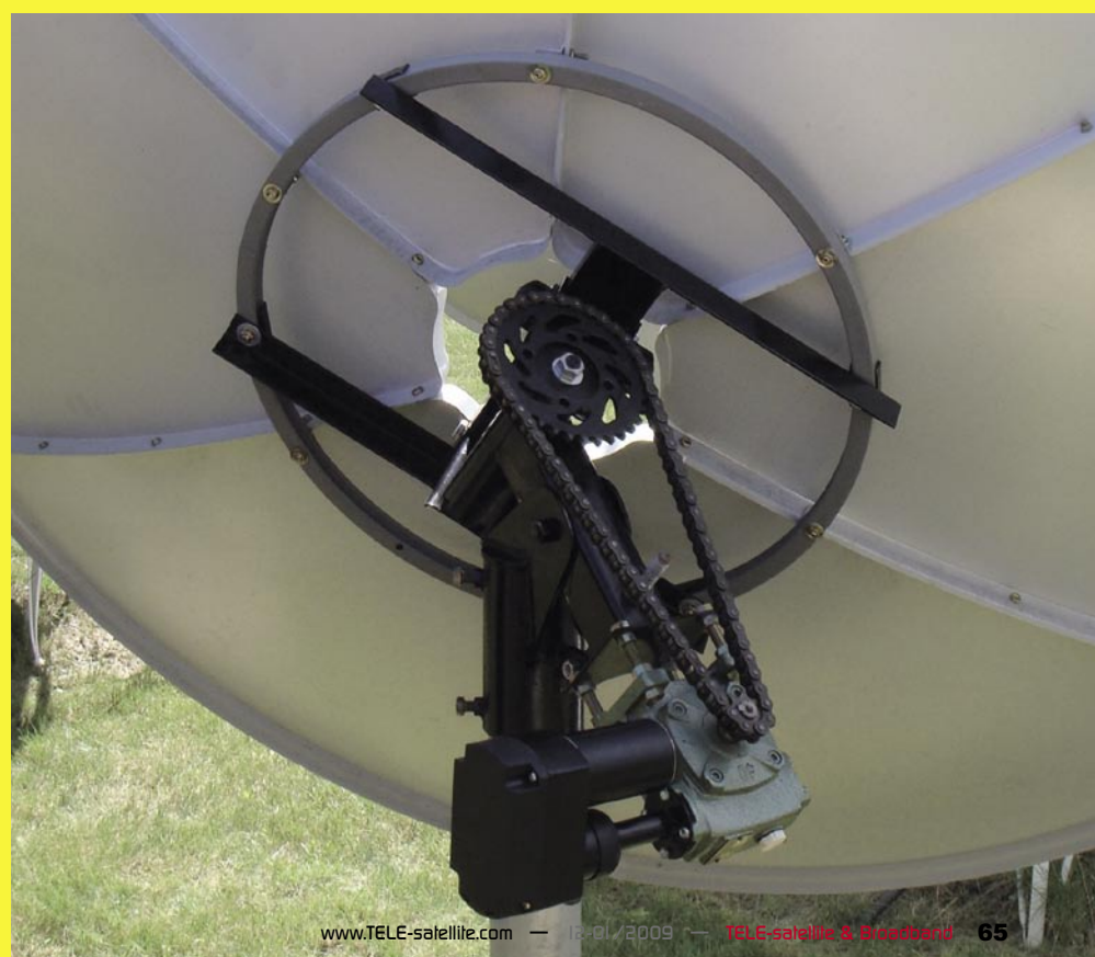
■ Motor da PT. Subur Semesta com uma corrente de transmissão da caixa de velocidades a partir do eixo
