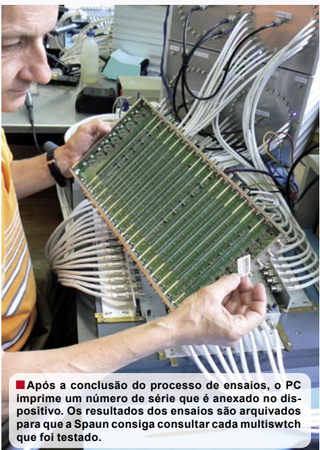
■ Todos os multiswitch são testados em múltiplas funções. O multiswitch está inserida na estação de ensaio e ao mover uma única alavanca todos os conectores "F" são inseridos e o processo de ensaio pode ser iniciado.
