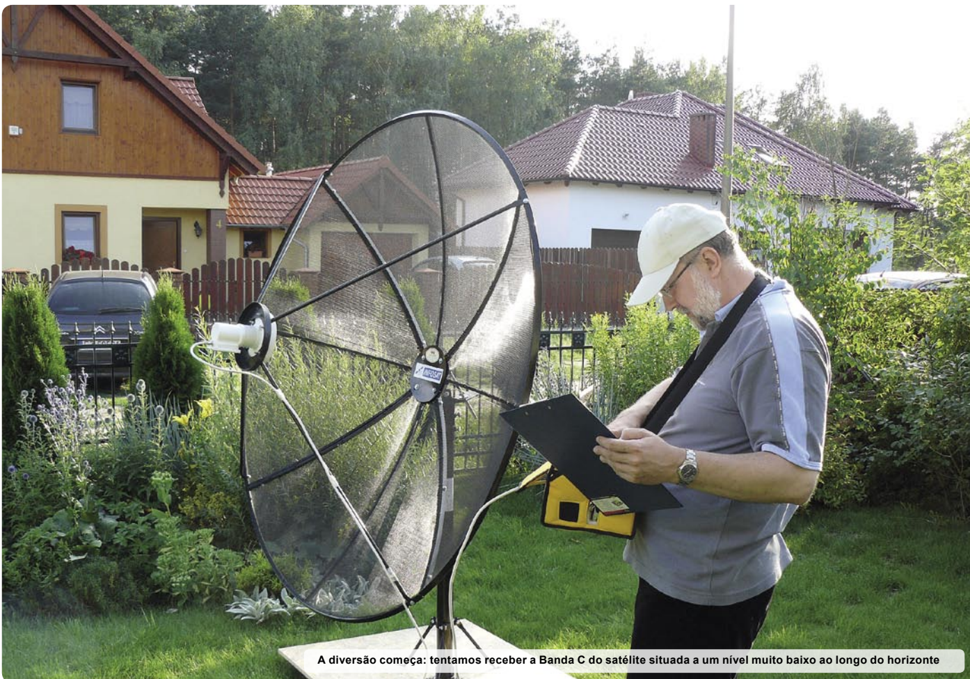
Chegou o momento de alinhar a antena. Recomendamos usar um nível da água equipados com ângulo - que irá permitir efectuar a fixação de elevação muito mais facilmente.
